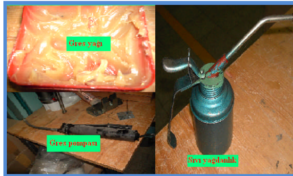
Resim 1.3: Gres, gres pompası ve sıvı yağdanlık
