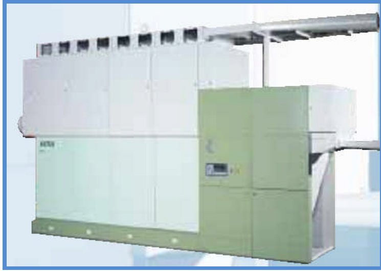
Resim 1.1: Unimix harman makinesi
